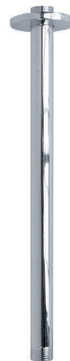
DUCH0IMP 62 Tubo de ducha techo redondo Largo: 300mm 1/2" (diámetro de conexión) Diámetro tubo: 25 mm
